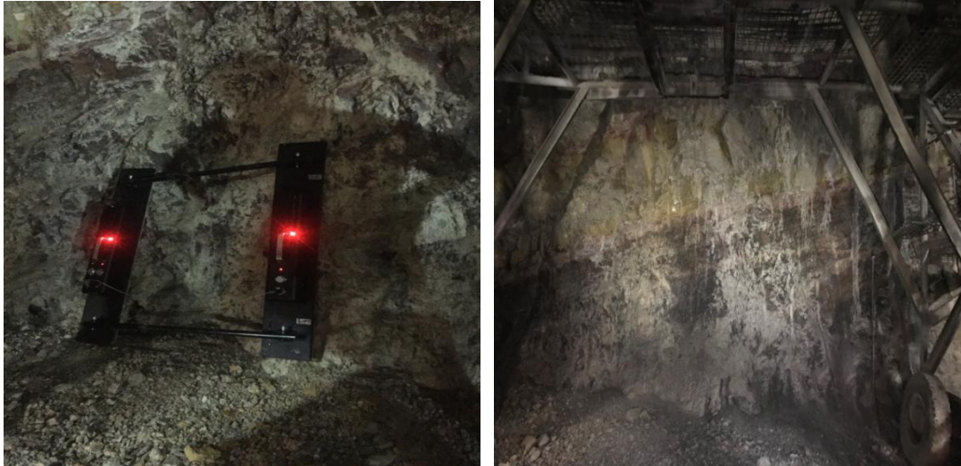
100MHz 地质雷达隧道超前预报现场
