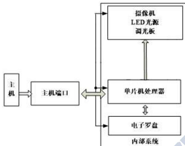
图2-4 探头原理框图
