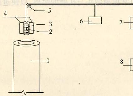
图 1 基桩孔内摄像设备连接示意
